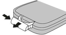
2. Retire la batería vieja e inserte una nueva batería de litio CR-2025 en el compartimiento de la batería.
