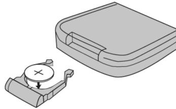
3. Después de cambiar la batería, vuelva a colocar el compartimiento de la batería en el control remoto hasta que encaje en su lugar.
