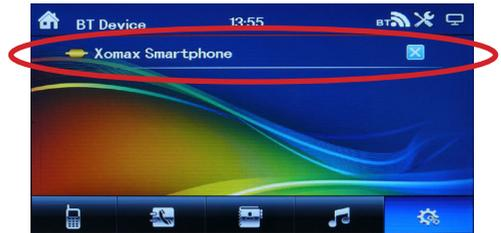
Es können mehrere Geräte mit dem Autoradio gekoppelt sein. Jedoch kann nur ein Gerät zur gleichen Zeit mit dem Autoradio verbunden sein. Möchten Sie ein anderes Gerät koppeln oder verbinden, müssen Sie die Verbindung zum anderen Gerät trennen.
