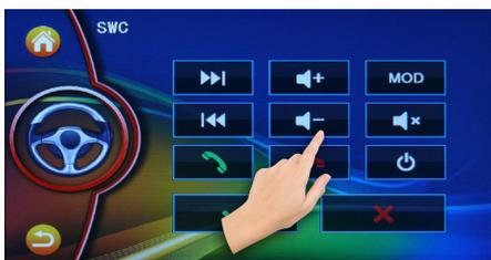
Anschließend drücken Sie die entsprechende Taste auf der Lenkradfernbedienung und halten Sie die gedrückt, bis die Einstellung gespeichert wird.
