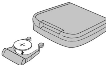
2. Enlevez la pile usagée et insérez une nouvelle pile lithium CR-2025 au compartiment à piles.
