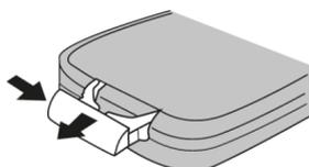
1. Enlevez le couvercle de la batterie en appuyant l'attachement vers la gauche tout en retirant le compartiment à piles.
