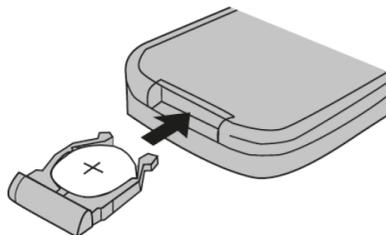
3. Après le remplacement de pile, remplacez le compartiment à piles dans sa position initiale dans la télécommande jusqu'à ce qu'il s'enclique en position.
