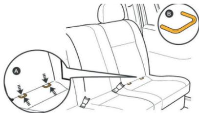
2. Die Top Tether Anker finden Sie entweder oben in der Nähe der Hutablage (Typ1), auf dem Fahrzeugboden hinter dem Sitz (Typ2) oder direkt auf der Rückseite der Rückenlehne (Typ 3).
