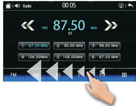
Tippen Sie auf die **LOC** - Sensortaste, um zwischen dem lokalen und entfernten Senderempfang umzuschalten.
