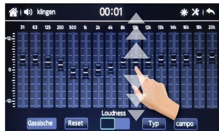
Tippen Sie auf die **Reset** - Sensortaste, um die Equalizer Einstellungen zurückzusetzen.
