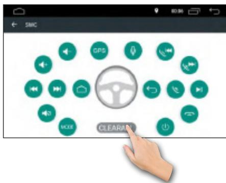
2. Drücken Sie zuerst eine Funktionstaste auf dem Lenkrad, die Sie zuordnen möchten. Danach drücken Sie eine beliebige Sensortaste auf dem Bildschirm. Die gewählte Funktion wird in blauer Farbe auf dem Display angezeigt.
